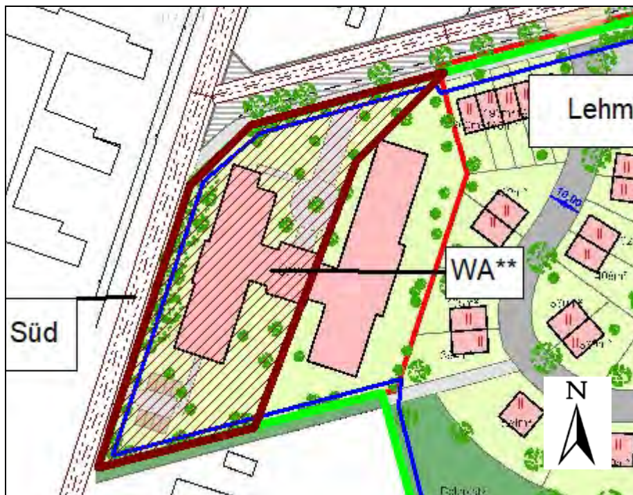
Abbildung 4 Darstellung des Bereiches in dem der Einbau von schallgedämmten Lüftungsöffnungen erfolgen sollte (WA**).
